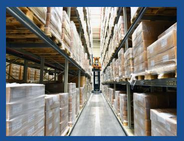
Das gesamte, innerhalb des Lagers verbaute, Regalsystem ist aus Metall gefertigt und die eingelagerten Waren sind gleichzeitig auch noch wasserhaltig und mit Aluminiumfolie geschützt. Infolgedessen kam es – durch sich ständig ändernde Ausleuchtungsverhältnisse und Reflexionsszenarien – zu Störungen der Funkwellen und damit Verbindungsunterbrechungen, sogenannten Blindspots, weshalb eine leistungsstarke, sich dynamischautomatisiert adaptierende Lösung gefunden werden musste.
